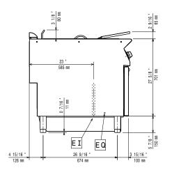
El = Elektroanschluss EQ = Equipotentialschraube
